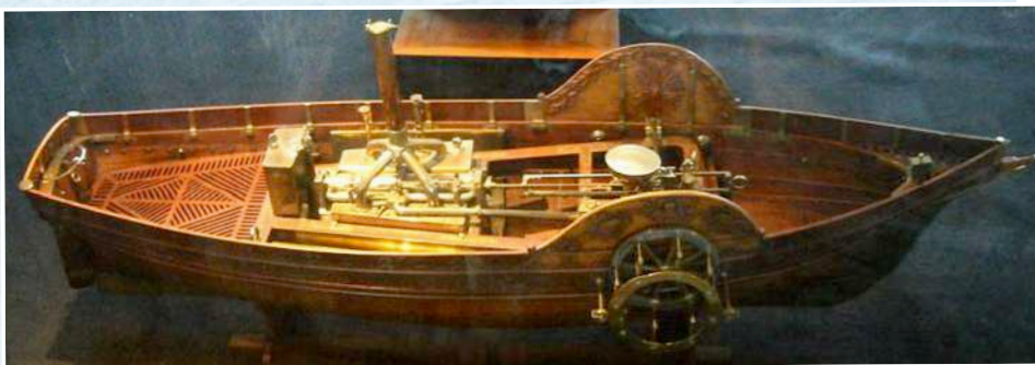
Maquette du pyroscaphe de Claude de Jouffroy d'Abbans, d'une longueur de 1,82 m (collections du musée de la Marine de Paris)
